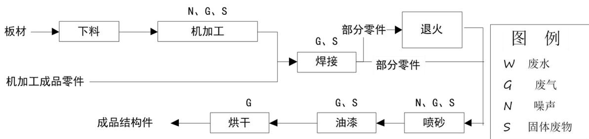
图 3-5 组件机加工工艺流程及排污节点
