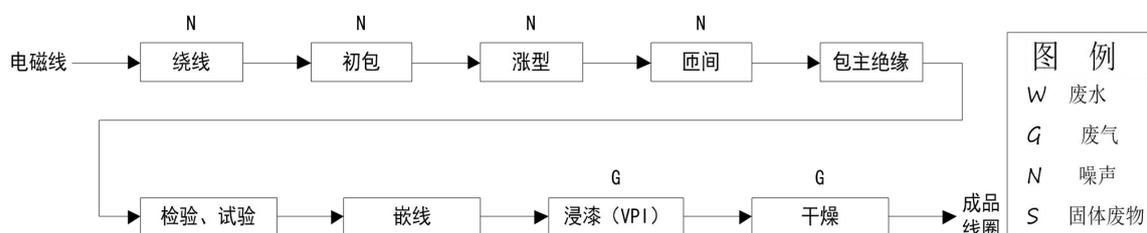
图 3-5 电工嵌线工艺流程及排污节点
