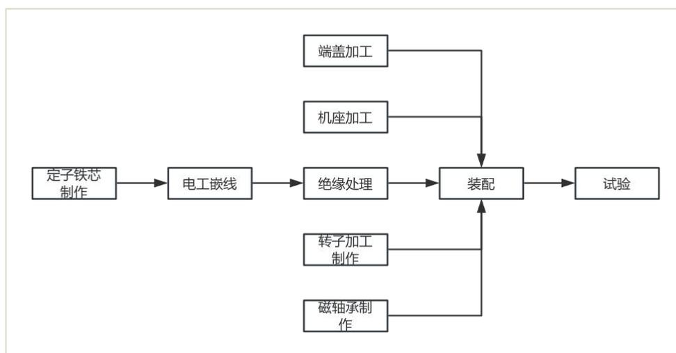
图4 运营期总体生产工艺流程图
